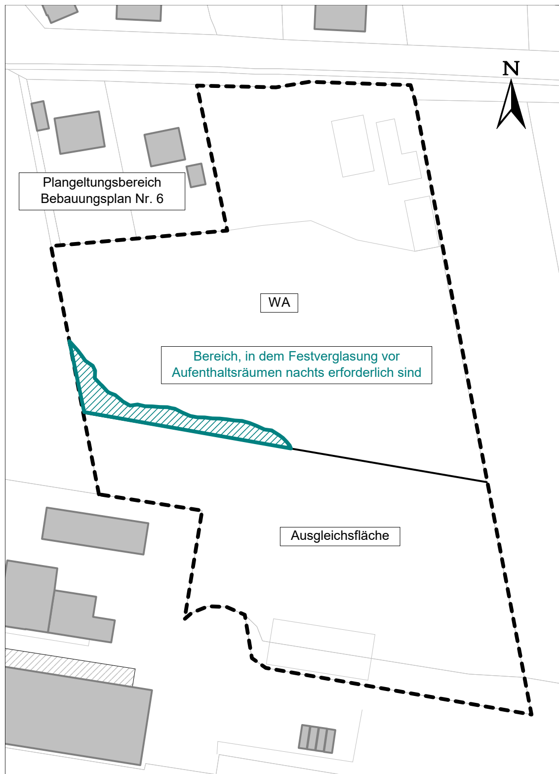
Abbildung 1: Bereiche des Plangeltungsbereichs, in denen der Immissionsrichtwert für Mischgebiet von 45 dB(A) nachts überschritten wird, Maßstab 1:1.250
