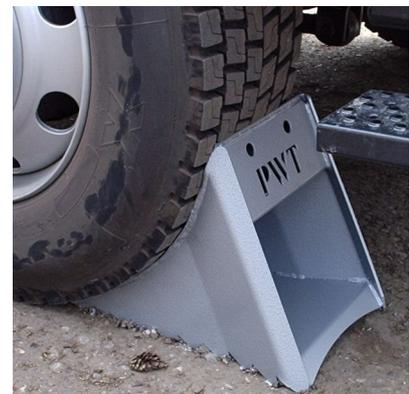
In Extremfällen, wie Absturzgefahr und bei rutschenden Unterlegkeilen, muss das Fahrgestell zusätzlich durch Ketten oder Anschlagseile an den Fahrzeugschäkeln oder an der Abschleppkupplung fixiert werden! Am schnellsten ist meist ein zweiter LKW als zusätzlicher Festpunkt einzusetzen. Weitere Festpunkte: Bäume oder Erdanker.
