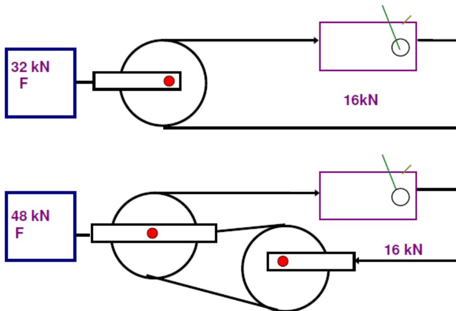
Durch das Einscheren von Rollen, wird die Zugkraft größer.
