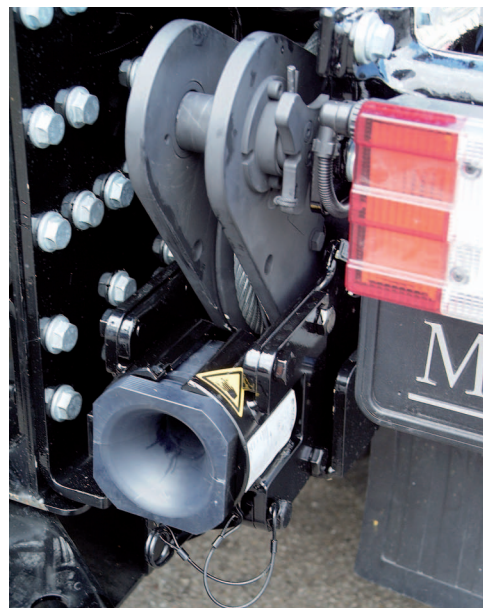
Platzsparende Umlenkombination mit Seiltrompete und Loser Rolle am Heck des Fahrzeuges
