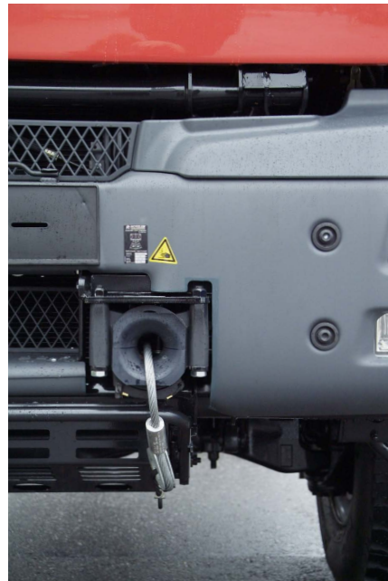
Platzsparender Einbau der Seiltrompete an der Fahrzeugfront
