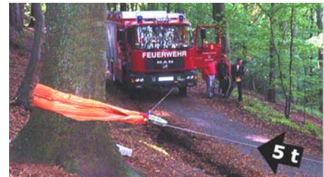
Trotz PWT-Rolle einsträngiger Zug! Die Rolle dient hier nur dem Richtungswechsel!
